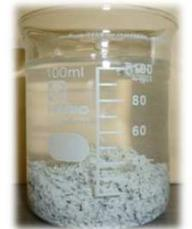
水性塗料を含むモルタル洗浄水
