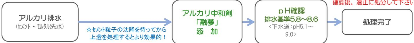
【処理B】セメント・モルタルに加え水性塗料などが混入している場合(セメント等浮遊物や色も除去したい場合)
